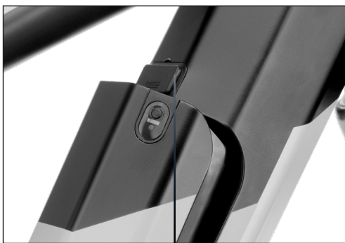
Pre vybratie batérie stlačte zámok/lock umiestnený na ráme elektrobicykla nad batériou
